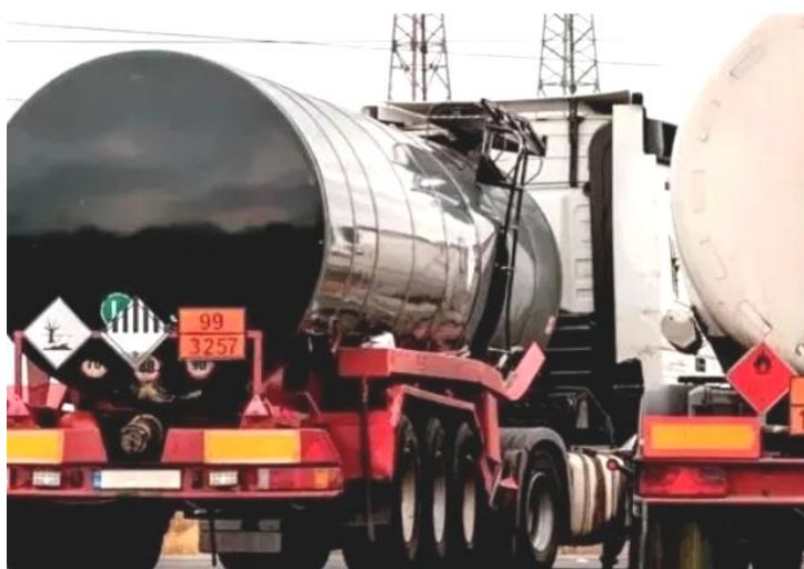
图 6：危险警告标志和代码安装在背面
